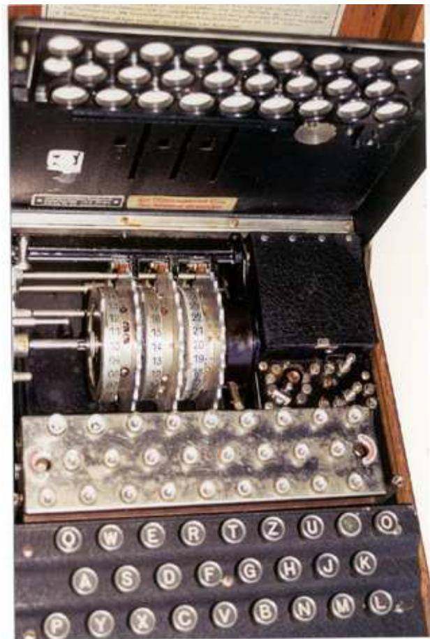
Bei der als Beispiel gezeigten Maschine handelt sich hier um eine 3-Walzen ENIGMA. Auf unserer Funkstrecke nach Panmunjom verwendeten wir allerdings eine 4-Walzen Maschine.
