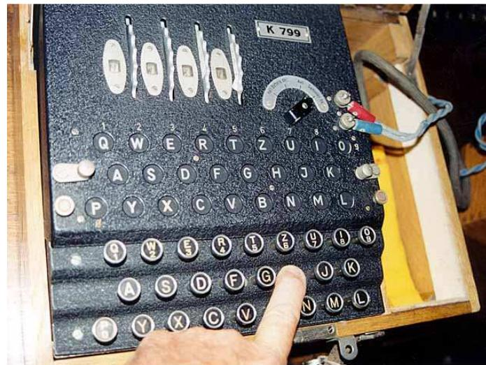
Hier ist die Abdeckung des Lämpchenfeldes einer deutschen 3-Walzen ENIGMA abgehoben. So konnten defekte Lämpchen ausgewechselt werden.
