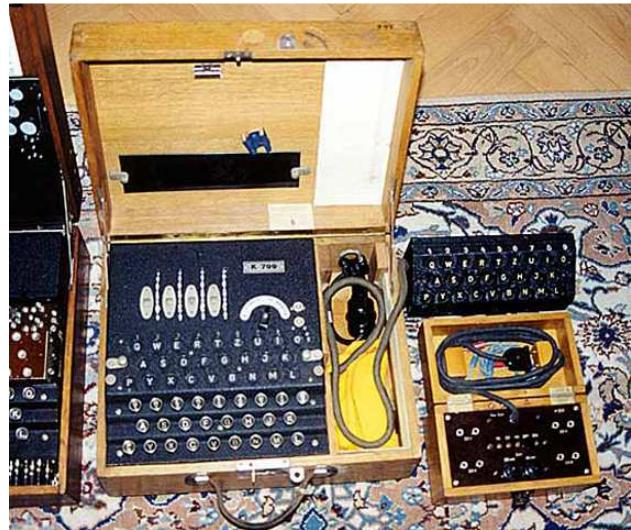
Zum Bedienen wurde die Kiste geöffnet, das zusätzliche Lämpchenfeld neben der Maschine auf den Tisch gestellt. Nun konnte ein Deckel abgehoben werden und nun waren die Innereien zugänglich. Durch lösen eines Sperrhebels konnte die Achse mit den Rotoren drauf herausgehoben werden. Die Walzen wurden entfernt um anschliessend gemäss den Schlüssel-Angaben aufgeschoben zu werden. Ebenso konnte bei jeder Walze der „innere Schlüssel“ eingestellt werden. Dazu später mehr.
